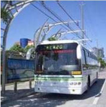
Die Kondensatoren Sinautec-Busse werden über Oberleitungen an Haltestellen wiederaufgeladen. Bild: Sinautec
